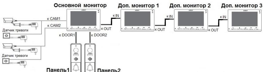
Вызывные панели подключаются только к основному монитору.
